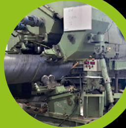
Formação e Solda Interna - SAW
